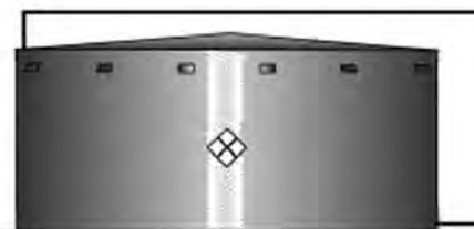
Tanque Cerrado con Tapa Flotante
