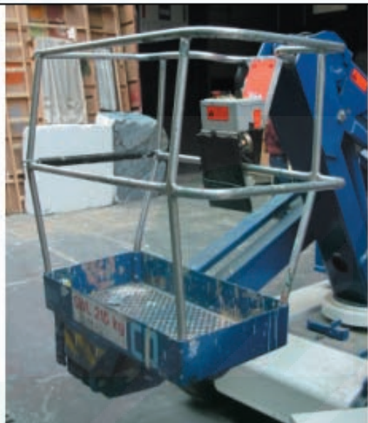
CESTA ELEVADORA CON BARANDILLA, TRAVESAÑO Y RODAPIE Además indicación de carga máxima
