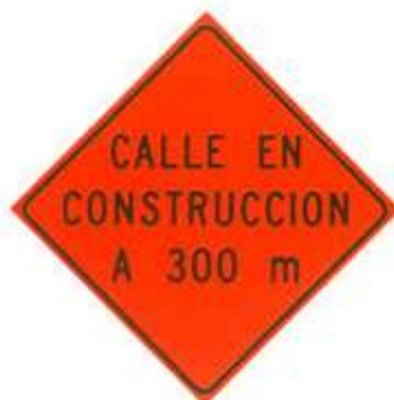
PC-1 CALLE EN CONSTRUCCION A ....m
