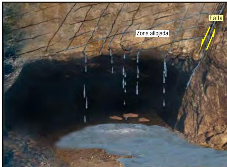
*Figura 2.22 Aflojamiento de la roca y deslizamiento a través de una falla por la presencia de agua.*
