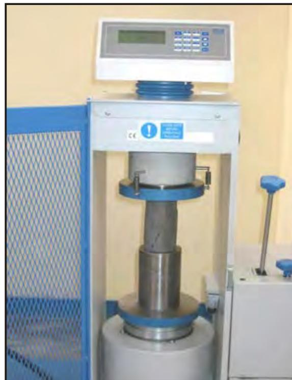
*Figura 4.34 Ensayo de compresión simple uniaxial.*
