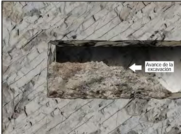
Figura 3.14 Avance favorable de la excavación con relación a las discontinuidades.
