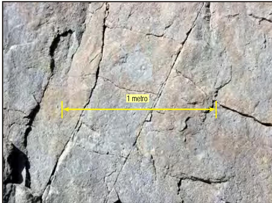
Figura 1.24 Roca masiva o levemente fracturada.
