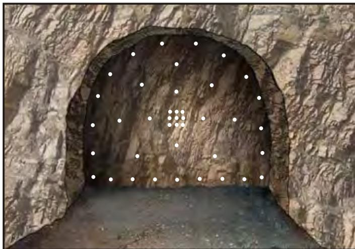
Figura 3.22 Diseño de malla de perforación.
