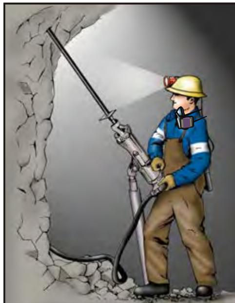
*Figura 4.13 Manera de instalación del SPLIT SET.*
