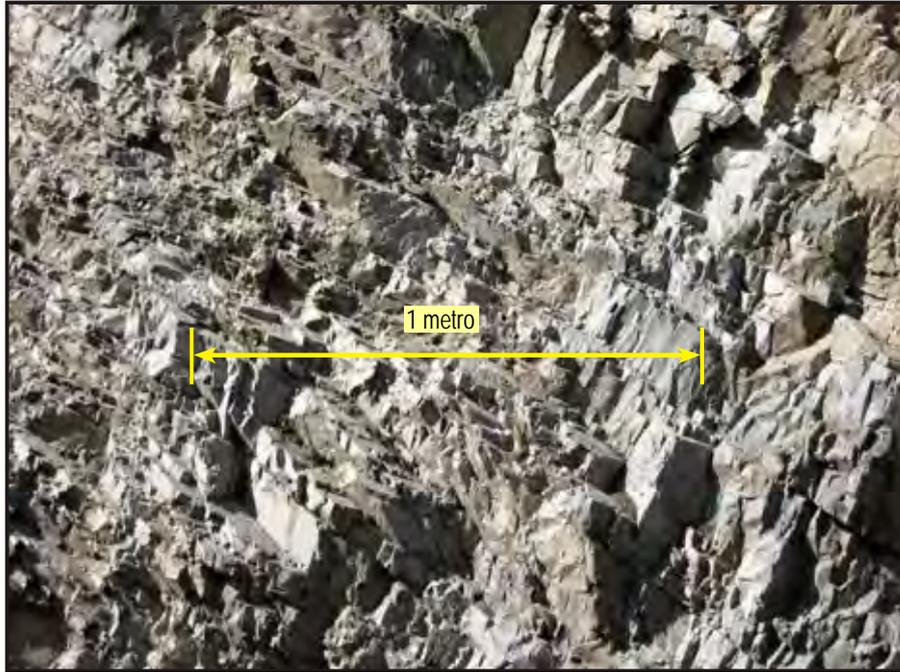
*Figura 1.27 Roca intensamente fracturada.*
