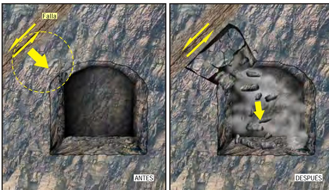
Figura 2.30 Problemas de inestabilidad cuando la excavación avanza paralela a una falla
