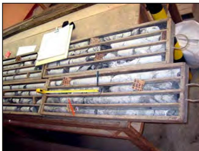
Figura 3.2 Testigos de perforación diamantina.
