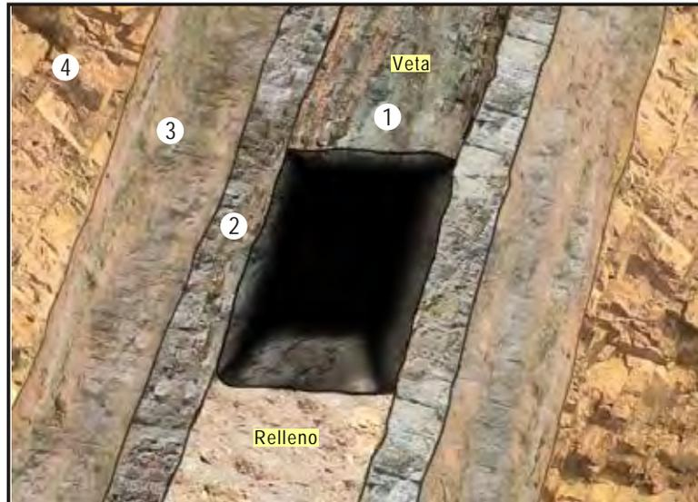
Figura 2.1 Zoneamiento simplificado de una estructura mineralizada.
