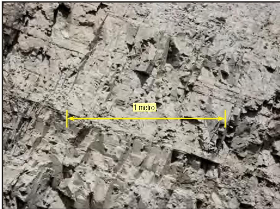
*Figura 1.26 Roca muy fracturada.*
