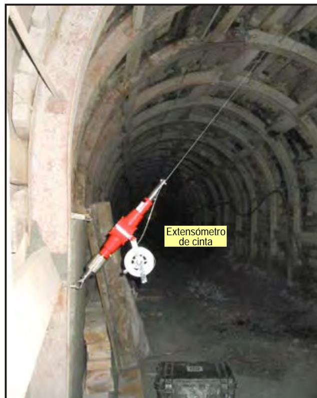
Figura 3.32 Control de la estabilidad usando equipos de instrumentación.
