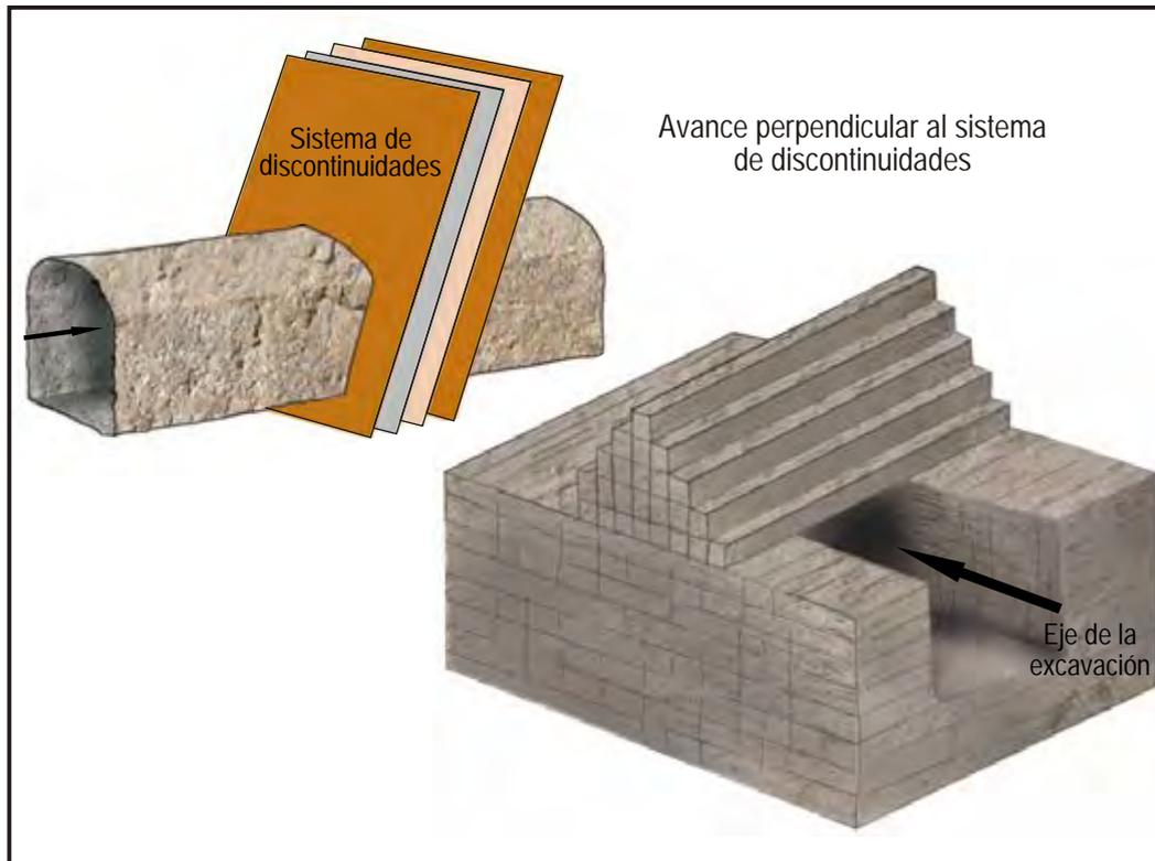
Figura 2.31 Condiciones de avance muy favorables para la estabilidad. La estructura rocosa funciona a manera de varillas apiladas en forma perpendicular a la excavación, las mismas que presentan buena estabilidad.
