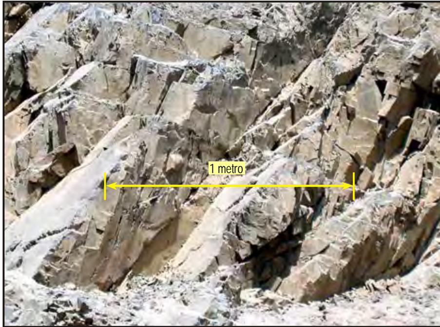
*Figura 1.25 Roca moderadamente fracturada.*
