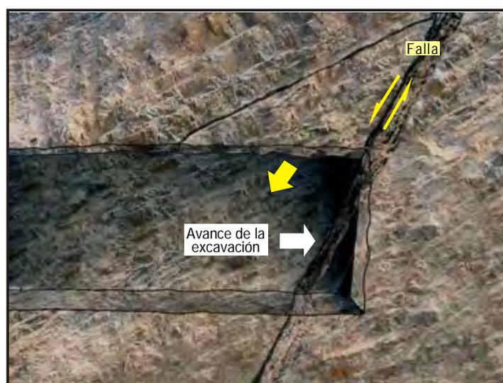
Figura 2.19 Deslizamiento a través de una falla.
